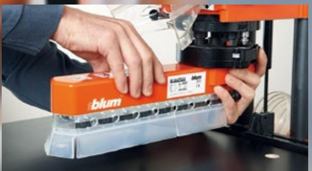
El cabezal portabrocas de 9 husillos para taladrado en línea en módulos en 32 mm y el cabezal portabrocas de 8 husillos para fijaciones frontales y guías de cuerpo garantizan un montaje preciso.
