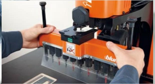
El cabezal portabrocas equipado, identificado también mediante un código de color, se emplea y se ajusta sin herramientas mediante un mando tensor.
