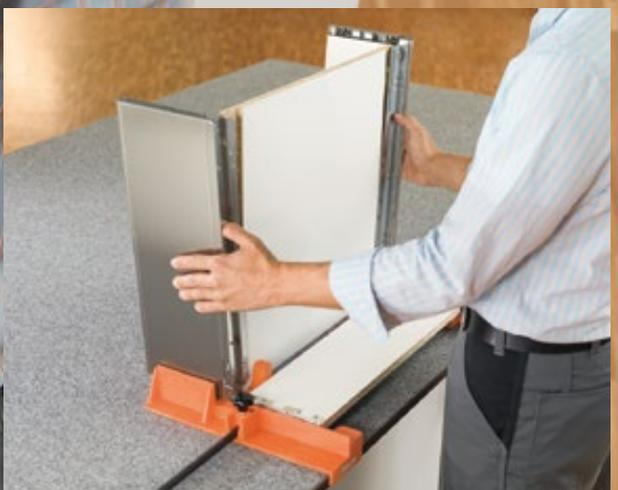
BOXFIX E-L le brinda un apoyo óptimo: Las piezas del cajón se pueden montar sin fisuras y con precisión sin tener que sujetarlos de manera incómoda.
