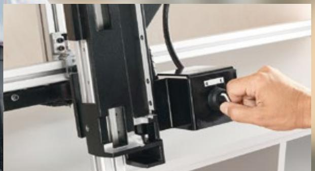
Las piezas de los cajones se fijan neumáticamente y a continuación se atornillan.
