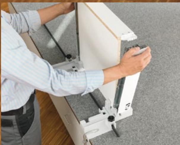
BOXFIX E-T permite ensamblar todos los componentes del cajón de manera cómoda y eficiente.
