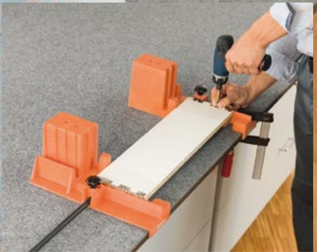
La trasera en madera y los soportes de trasera pueden atornillarse sin fisuras y con precisión.
