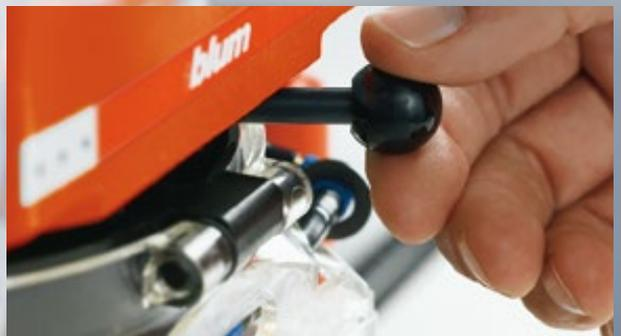
Con el cabezal portabrocas giratorio múltiple podrá efectuar diferentes esquemas de taladrado para herrajes para muebles de manera rápida, precisa y sin herramientas.
