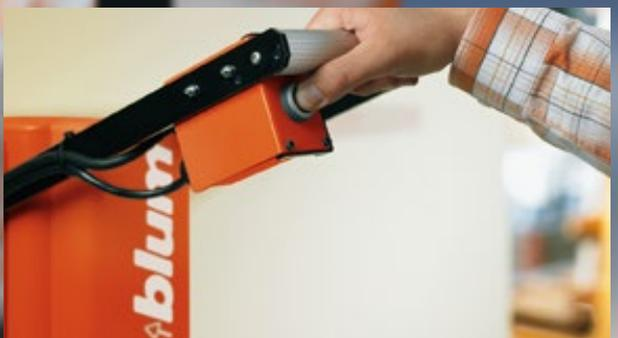
Para realizar un taladrado preciso hay que mover la palanca manualmente hacia abajo.
