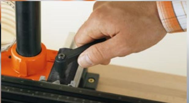
La distancia del taladrado se fija con exactitud mediante una palanca de sujeción.
