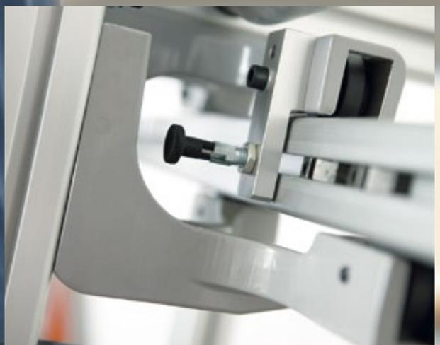
Los topes para ajustar el ancho y la altura de las traseras de mueble se pueden fijar rápida y fácilmente.
