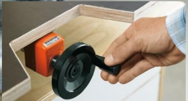
La cota de taladrado se ajusta con exactitud en la pantalla digital mediante un husillo.
