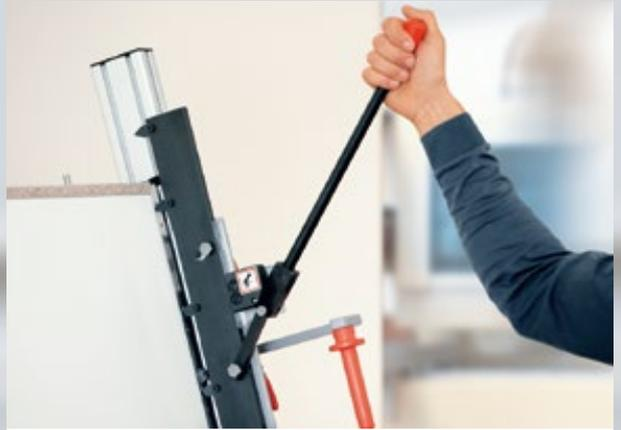
Gracias a su técnica perfeccionada se requiere muy poca fuerza para unir a presión los fondos y los perfiles. A través de su estructura ergonómica, BOXFIX PRO permite realizar el trabajo en posición erguida.
