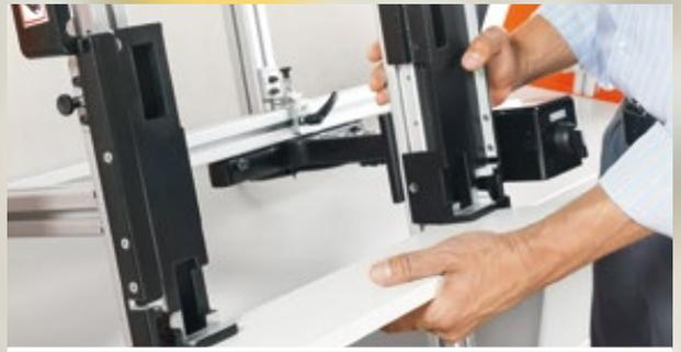
La altura y los anchos de las traseras son de ajuste variable. Los ajustes que siempre se repiten pueden establecerse de antemano con un tope de ancho adicional.
